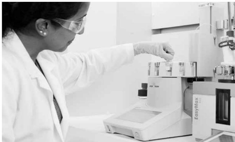
de remplissage. L'échantillon est ainsi mis à tremper, avant d'être dilué à une concentration pré-définie par l'opérateur. Il est ensuite transféré dans un flacon, prêt pour l'analyse hors ligne, tandis que la sonde est automatiquement purgée, en attente d'une nouvelle utilisation. »
